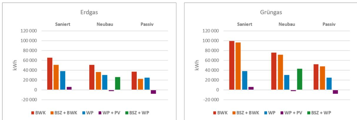
Die CO<sub>2eq</sub>-Emissionen im Hotel sind in Abbildung 23 dargestellt. Das Brennstoffzellen-System (Brennstoffzelle plus Wärmepumpe) ermöglicht auch bei der Verwendung von Erdgas deutliche Reduktionen im Vergleich zum Referenzsystem Brennwertkessel und nähert sich dem
