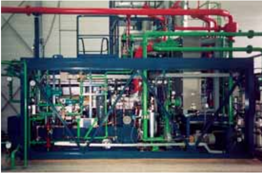
Dampfschraubenmotoranlage mit einer elektrischen Nennleistung von 250 kW el
