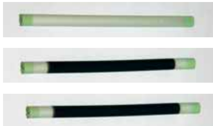
Co-gesinterte NiO-YSZ/YSZ und NiO-YSZ/YSZ/LSM Röhrchen Foto: ARC Austrian Research Centers GmbH
