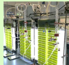
Abb. 4. In situ -Extraktion im semi-technischen Maßstab (6 L FPA).
