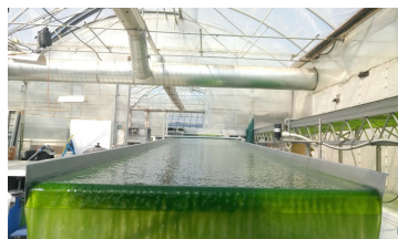
Abbildung 4: Kultivierung von Synechococcus leopoliensis im offenen Dünnschichtreaktor.
