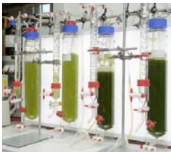
Abb. 2. In situ -Extraktion im Labormaßstab.
