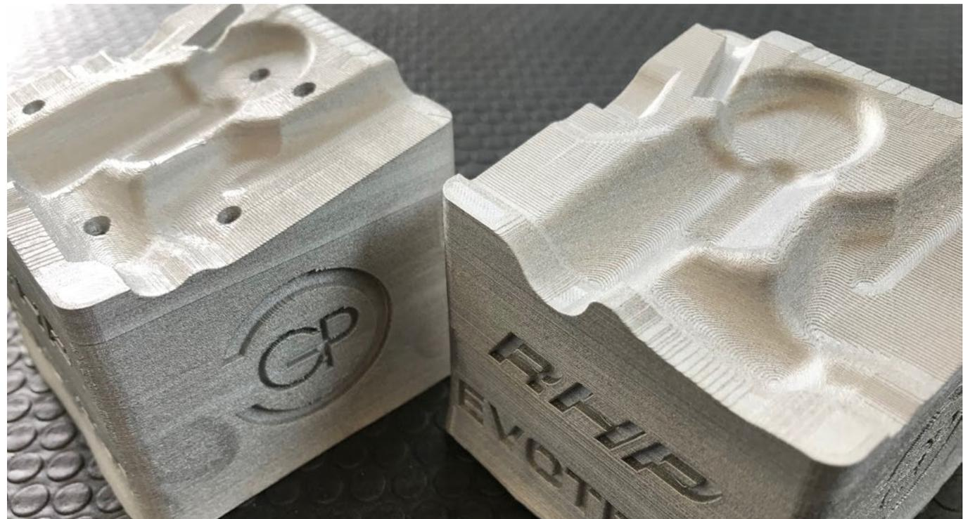
Foto: Vakuum-Spannbacken additiv gefertigt ©Hannes Steiner, RHP-Technology
