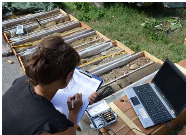
Wärmeleitfähigkeitsmessungen am Bohrkern, Foto: Heat Harvest-Konsortium
