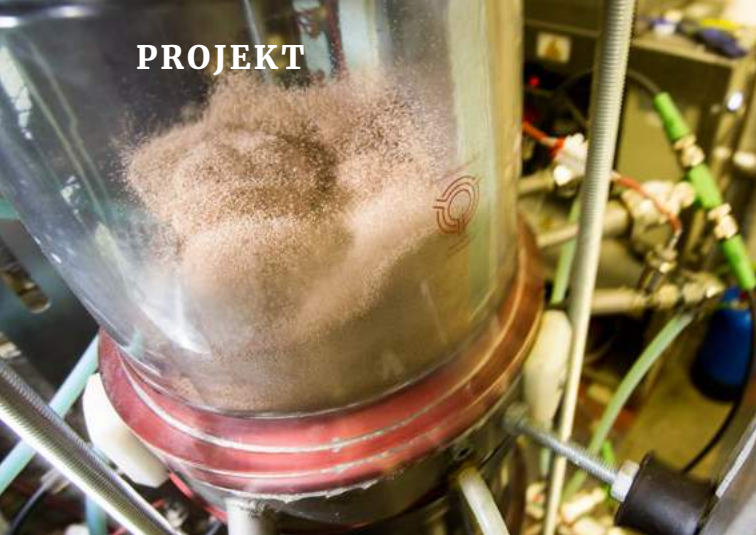
Detailaufnahme einer Wirtelschicht, Foto: TU Wien, Institut für Chemische Verfahrenstechnik und Energietechnik
