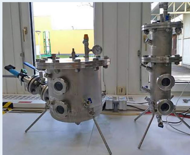
Rieselbettreaktor und CSTR (Continuous stirred-tank reactor) im Kleinmaßstab, Foto: Universität für Bodenkultur Wien, Institut für Umweltbiotechnologie
