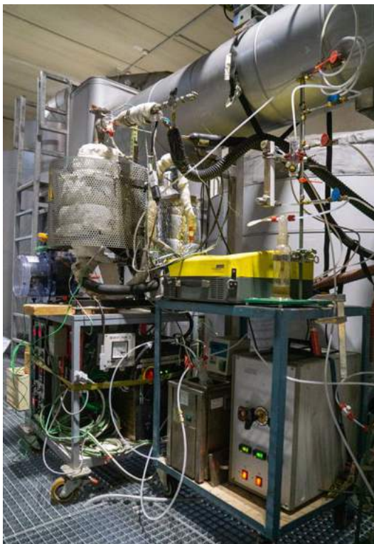
Aufbau zur Untersuchung von der adsorptiven Entschwefelung mit Online-Gasanalyse (FTIR), Foto: BEST / Lagler
