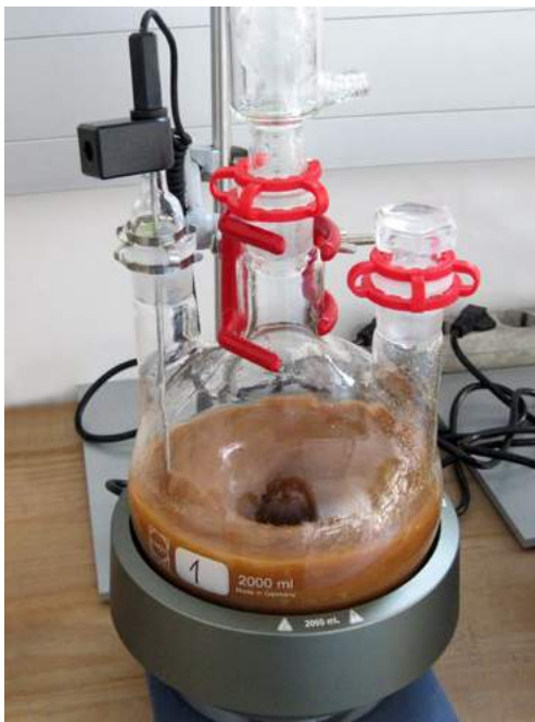
Testaufbau für Leaching-Tests, Foto: BIOS Bioenergiesysteme GmbH
