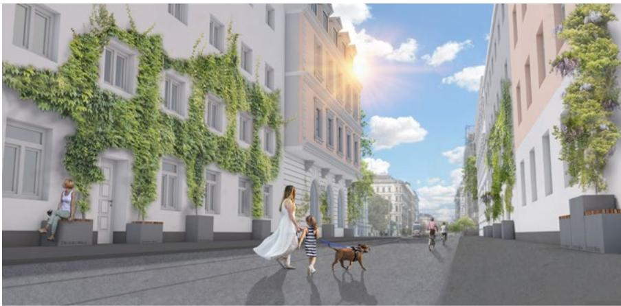
Die 50 Grünfassaden-Module werden straßenseitig montiert. Sie eignen sich sowohl für Bestandsgebäude als auch für Neubauten. Die Montage ist auch an gedämmten Fassaden möglich. Die 100 x 40 cm großen, stabilen Trägere sind aus Faserzement gefertigt.
