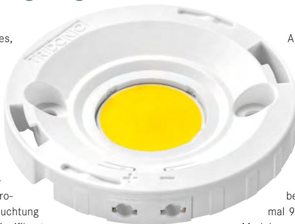
Auf Basis dieser Forschungsarbeiten brachte Tridonic Jennersdorf GmbH als nachhaltige Systemlösung für LED-Down- und -Spotlights das LED Modul TALEXX engine STARK SLE auf den Markt, das sich durch seine hohe Effizienz (bis zu 156 Lumen pro Watt) auszeichnet und eine Lebensdauer von 50.000 Stunden bei einem Lichtstromabfall auf maximal 90 Prozent erreicht. Über 960.000 Module wurden bisher mit den im ADLED-Projekt entwickelten Substraten gefertigt.
