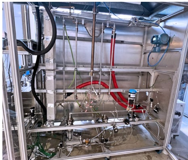
Aufbau einer katalytischen Methanisierung, Foto: K1-MET GmbH
