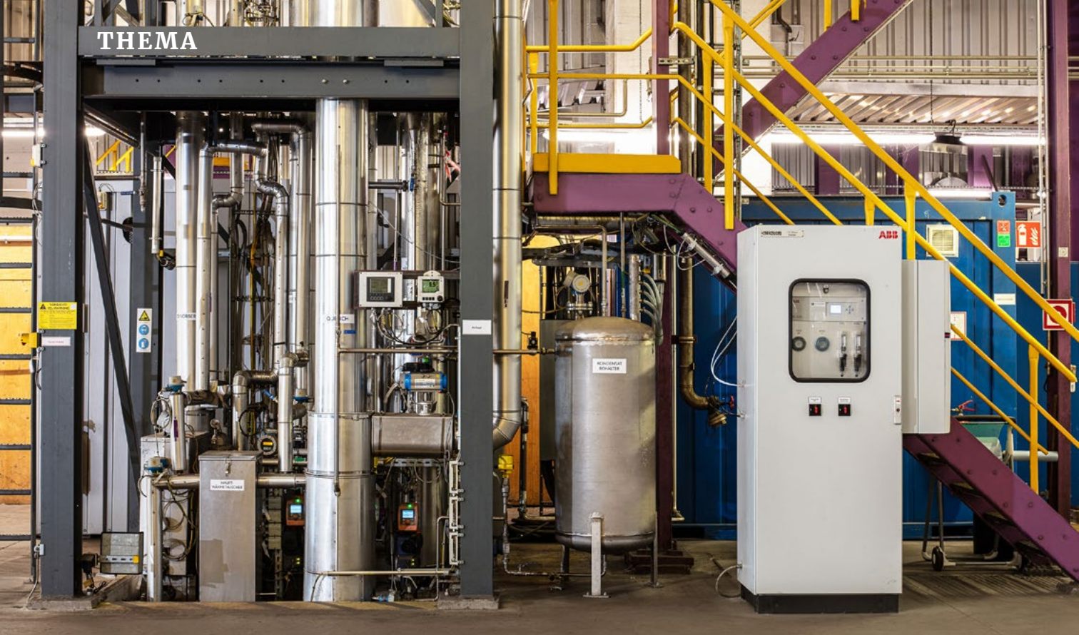
Aminwäscher zur Abscheidung von CO 2 , Foto: voestalpine Stahl GmbH
