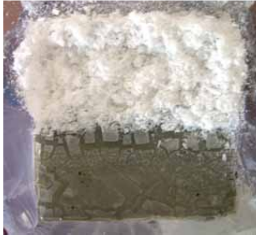
Abbildung 45: Rekrystallisationserscheinung des Füllmaterials bei Verwendung von wasserhaltiger Membranlösung
