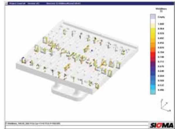
Abbildung 27: Simulation der Bindenähte am Beispiel PPSU
