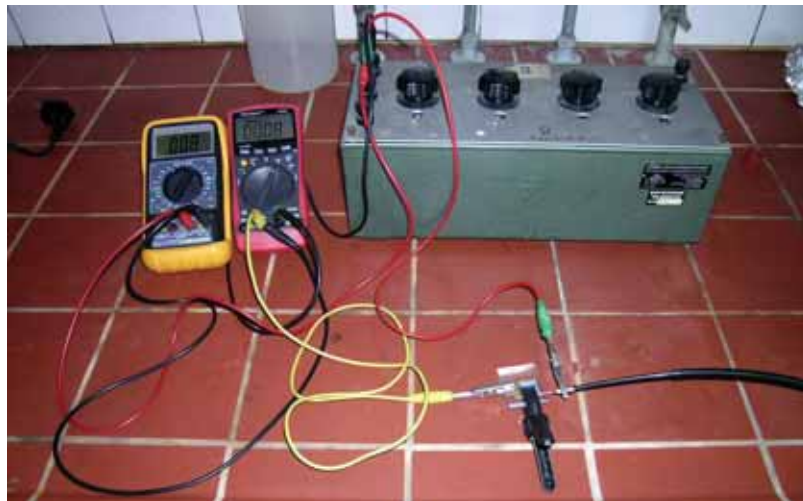
Abbildung 92: Realisierter Messaufbau zur Aufnahme des U/I Verlaufes
