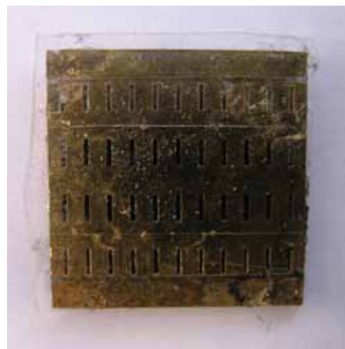
Abbildung 90: Basisplatte mit Membran, Katalysator und Ableitungen (Rückseite)
