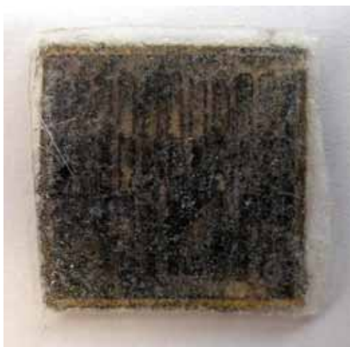
Abbildung 89: Basisplatte mit Membran, Katalysator und Ableitungen (Vorderseite)
