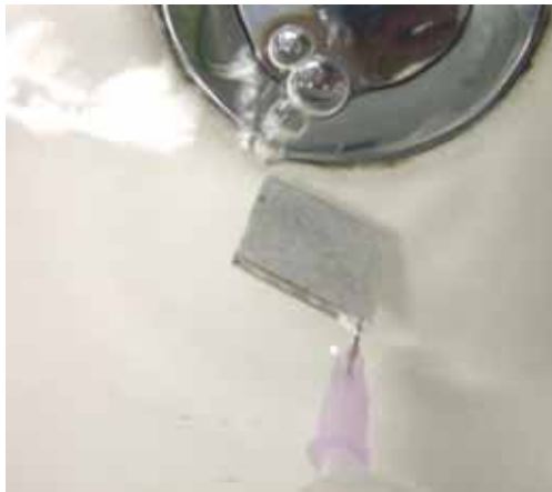
Abbildung 83: Dichtheitsprüfung der EasyCell unter Wasser
