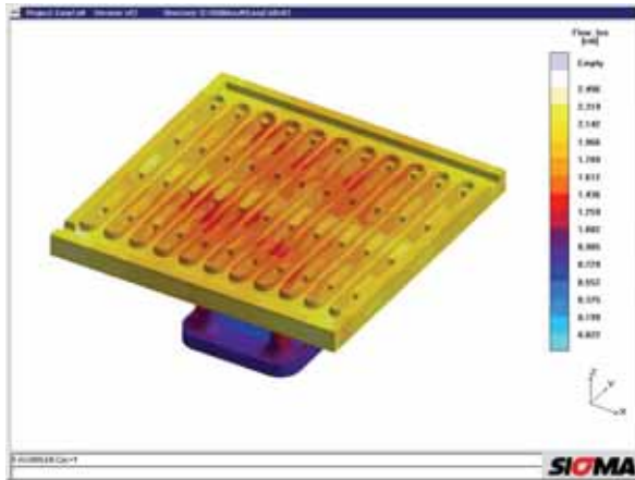
Abbildung 26: Simulation der Fließweglängen am Beispiel PPSU
