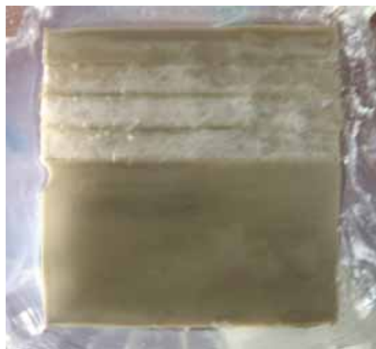
Abbildung 44: Versuchsplatte mit aufgebrachtter Membranlösung nach dreistündiger Trocknungszeit
