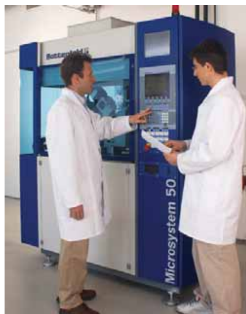
Abbildung 32: Battenfeld Mikrospritzgießmaschine vom Typ Microsystem 50
