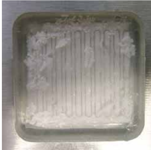
Abbildung 70: Füllstoff 1 mit Kristallisation an der Oberfläche
