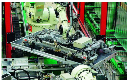
Abbildung 34: Vollautomatisierte Kollektorproduktion beim oberösterreichischen Unternehmen Sun Master Energiesysteme
