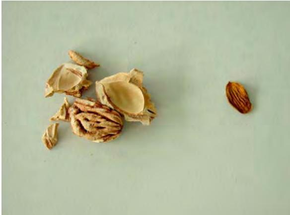
Abb. 16 Brechversuch Pfirsich, Methode: Kernbrecher mit je nach Kaliber einstellbarem Brechschlitz, © Hanswerner Mackwitz
