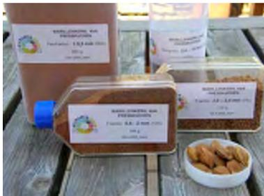
Anschließend wurde der Presskuchen im Labor mit Mörser, Pistill und Kenwood Küchenmaschine zerkleinert und mithilfe von Sieben verschiedene Korngrößen (-0,5 mm, 0,5-2 mm Durchmesser) hergestellt.
