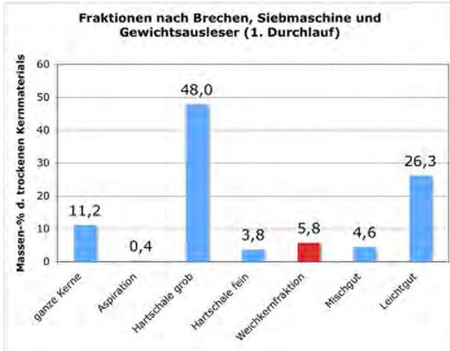
Abb. 21 Fraktionen nach Brechen mit Walzenbrecher und Auftrennen mit Siebmaschine (inkl. Windsichter) und Gewichtsausleser (alle Ströme erfasst; Versuche bei Cimbria Heid, eigene Grafik)
