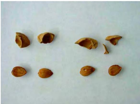
Abb. 15 Brechversuch Marille, Methode: Kernbrecher mit je nach Kaliber einstellbarem Brechschlitz, © Hanswerner Mackwitz
