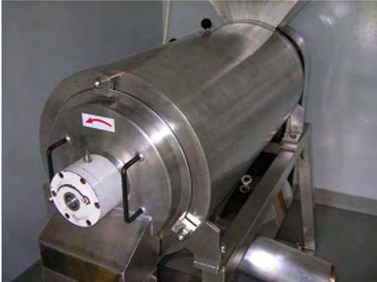
Abb. 12 Siebtrommel zur Entkernung von Steinobstkernen (© Agardi Destillerie, Ungarn)
