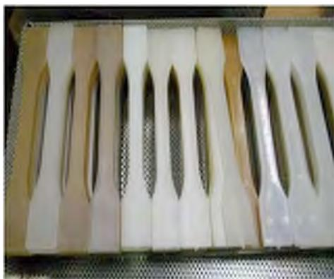
Die Hartschalenkernmehle der Obstschalen (Partikelgröße 20 Mikrometer) lassen sich auch in höheren Konzentrationen problemlos in eine Polymerschmelze einarbeiten. Dieser neue Werkstoff hat Eigenschaften, die mit jenen von holzfaserverstärkten Polymeren vergleichbar sind. Die mechanischen Kennwerte von den mit „klassischen“ Füllstoffen verstärkten Polymeren können jedoch mit den Lignozellulose-Füllstoffen nicht erreicht werden.
