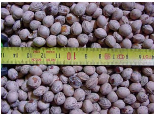
Abb. 25 Ganzkern-Fraktion nach der Siebmaschine (Schlitzsieb 5,00mm)
