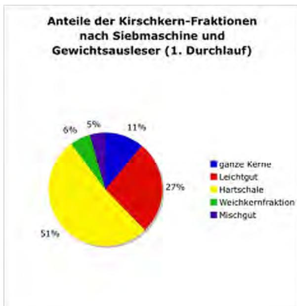
Abb. 20 Fraktionen nach Brechen mit Walzenbrecher und Auftrennen mit Siebmaschine (inkl. Windsichter) und Gewichtsausleser (Fraktionen tw. zusammengefasst; Versuche bei Cimbria Heid, eigene Grafik)
