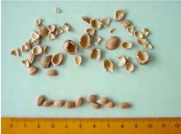
Abb. 14 Brechversuch Kirsche, Methode: Kernbrecher mit je nach Kaliber einstellbarem Brechschlitz, © Hanswerner Mackwitz
