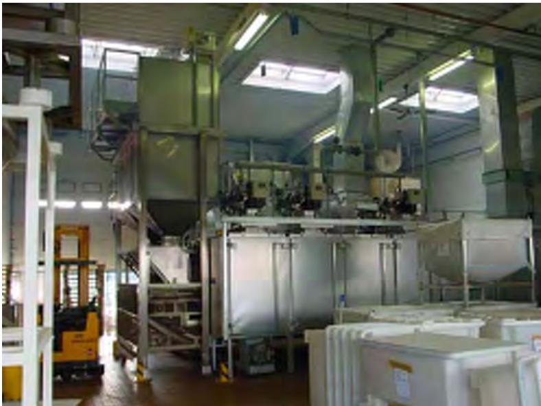
Abb. 30 Röstanlage (Seitenansicht; Quelle: [www.koenig-backmittel.de](http://www.koenig-backmittel.de), abgerufen am 8.3.2006)
