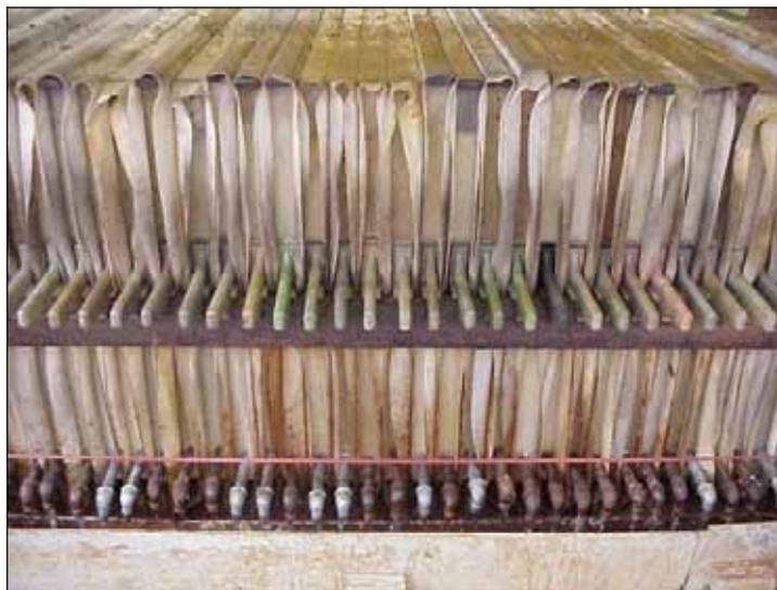
Abbildung 2: Kammerfilterpresse, Filterplatten-Seitenansicht
