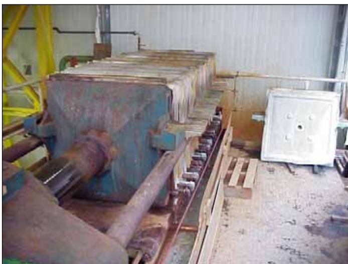
Abbildung 1-1: Kammerfilterpresse
