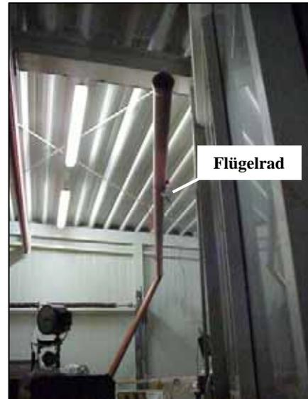
Abbildung 3-3: Luftmengenmessung
