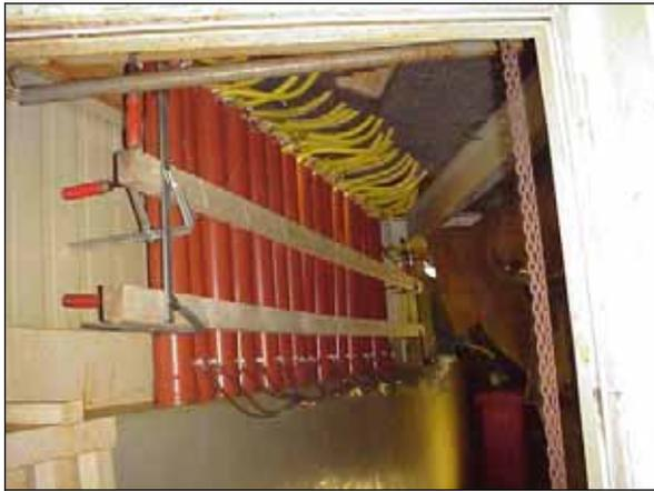
Abbildung 3-5: Ablaufmengen-Messbehälter
