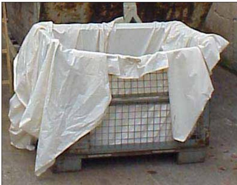
Abbildung 3-12: Gitterbox zum Trocknen des Filterkuchens
