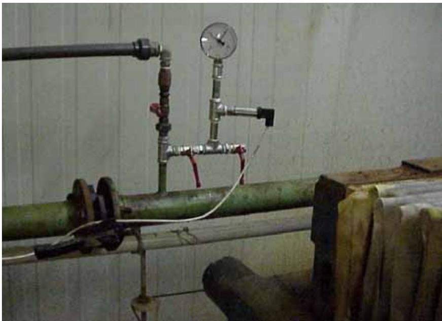
Abbildung 3-9: Druckmessstelle am Eingang der Kammerfilterpresse
