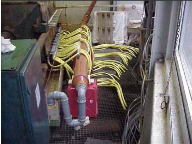
Abbildung 3-2: Messaufbau mit Luft/Wasser-Abscheider
