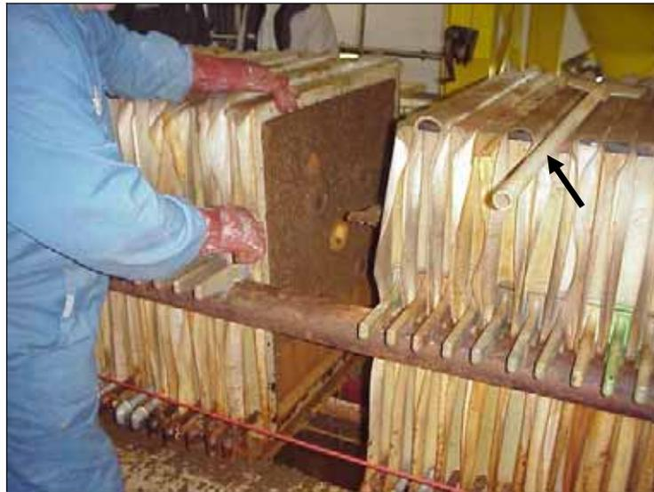
Abbildung 3: Händisches Abreinigen des Filterkuchens durch Schütteln der Filtertücher und gegebenenfalls mittels eines Schabers (Pfeil)
