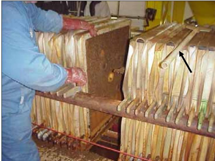
Abbildung 1-3: Händisches Abreinigen des Filterkuchens durch Schütteln der Filtertücher und gegebenenfalls mittels eines Schabers (Pfeil)
