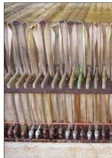
Abbildung 1-2: Filterplatten-Seitenansicht
