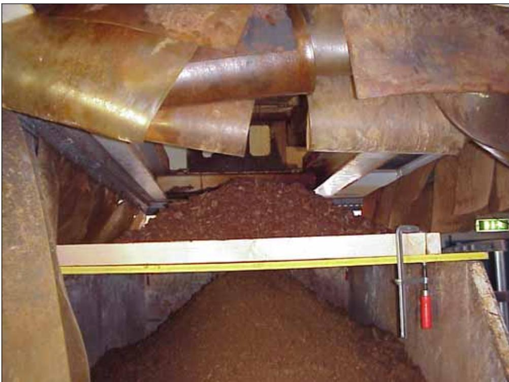
[Abbildung 3-10](#): Auffangplattform für den Filterkuchen auf dem Container unter der Kammerfilterpresse
