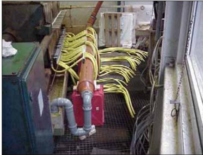
Abbildung 5: Messaufbau zum Erfassen des zeitlichen Verlaufes von Druckluftverbrauch und Entwässerungsfortschritt am Filter
