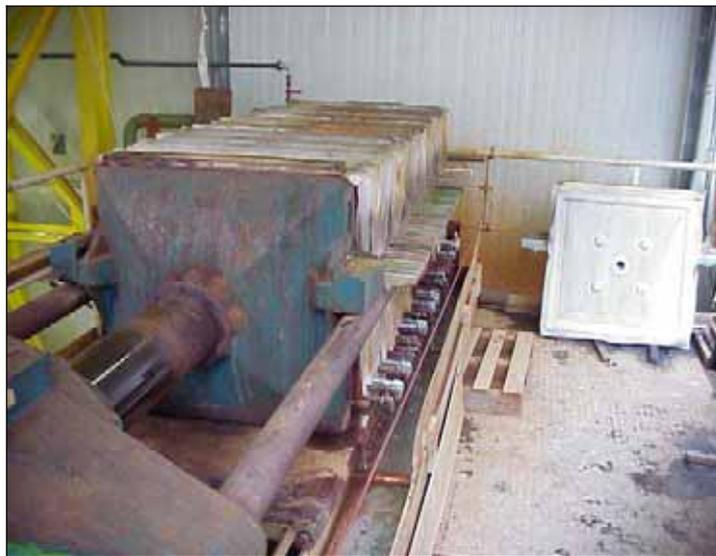
Abbildung 1: Kammerfilterpresse
