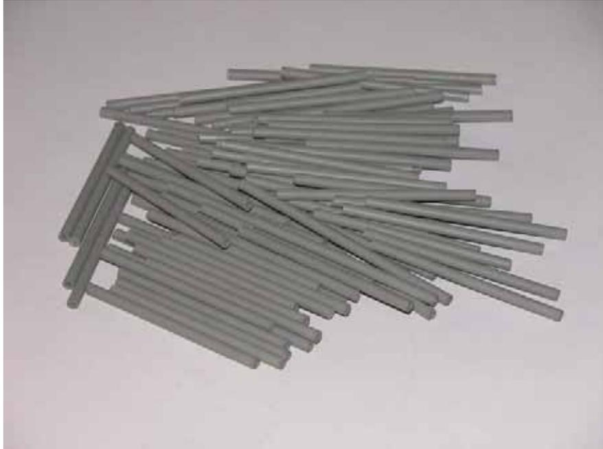
**Abb. 3-34:** NiO/YSZ Anodensupports hergestellt mittels PIM
