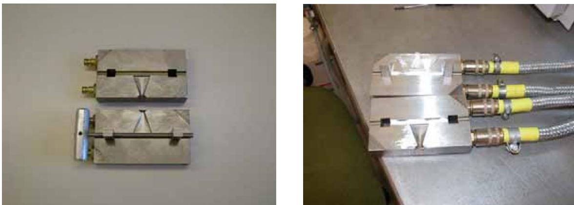
Abb. 3-10: Temperierbares Werkzeug für YSZ-Röhren mit variabler Einstellung der Röhrenwandstärke
