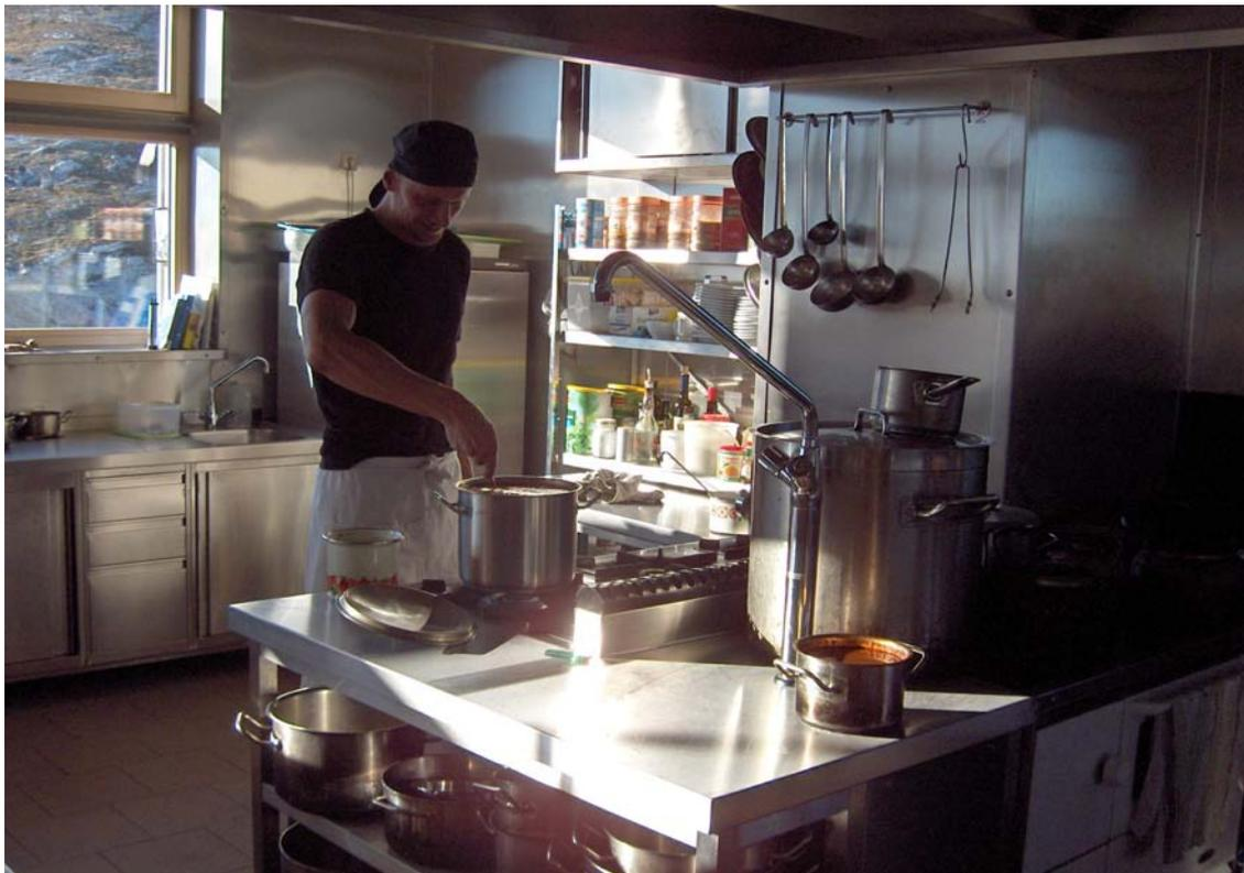
Im Bereich von Schank- und Essensausgabe kamen äußerst robuste Phenolcompactplatten zum Einsatz, während die Küche aufgrund der strengen Hygienevorschriften vollständig mit Nirosta ausgestattet ist.
