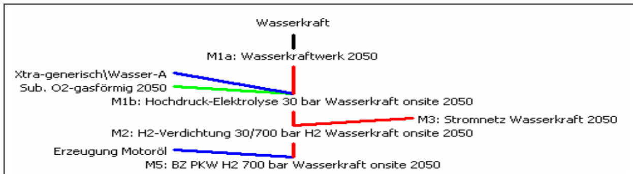
Abbildung D- 10: Prozesskette „BZ-PKW 2050 GH Wasserkraft“
