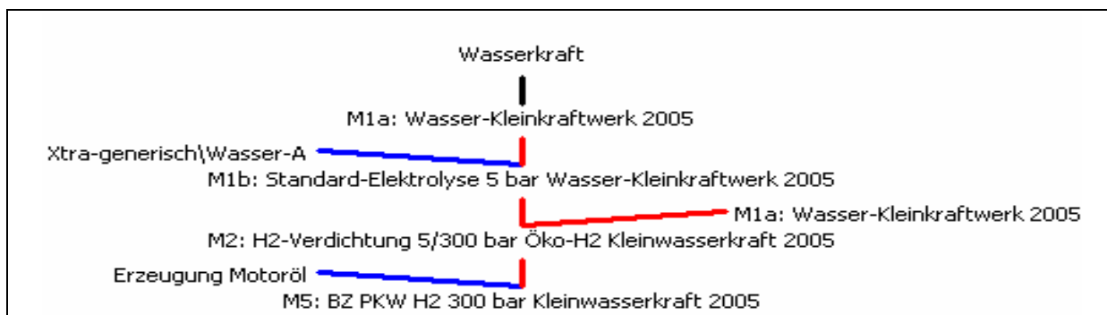
Abbildung D- 3: Prozesskette „BZ-PKW 2005 GH Kleinwasserkraft“
