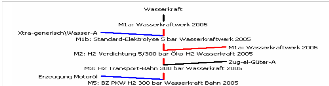
Abbildung D- 21: Prozesskette „BZ-PKW 2005 GH Wasserkraft Bahn 300 bar“
