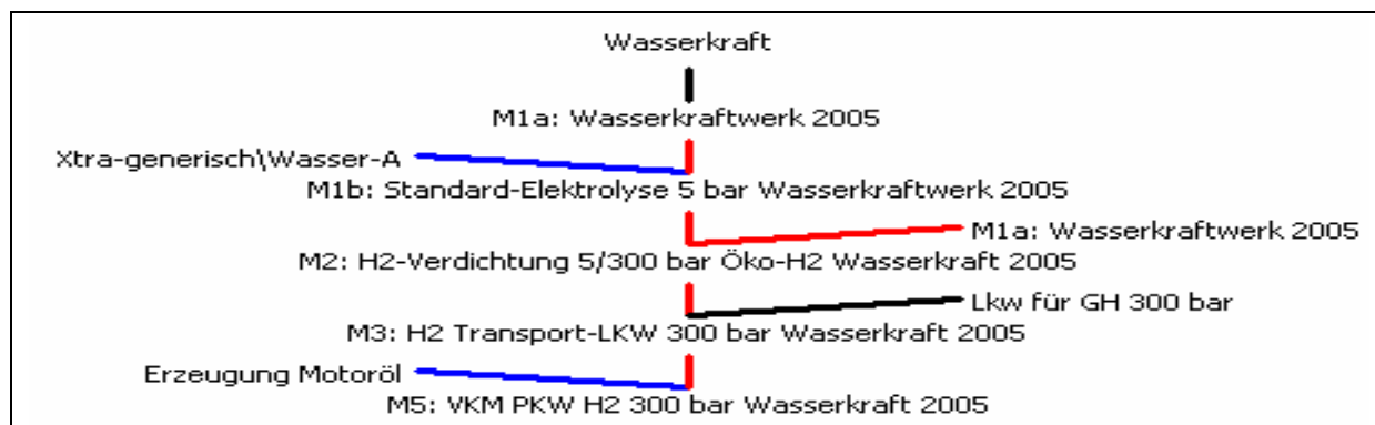
Abbildung D- 25: Prozesskette „VKM-PKW 2005 GH Wasserkraft onste 300 bar“
