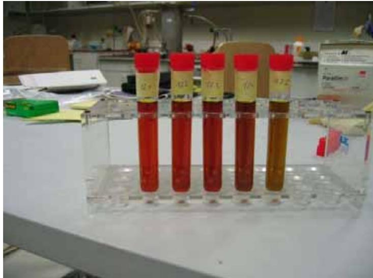
Abbildung 63: Farbveränderung der Beizen. Links die Nulllösung. Die Farbe der Beizproben wechseln mit zunehmender Beizdauer von braun nach grün.
