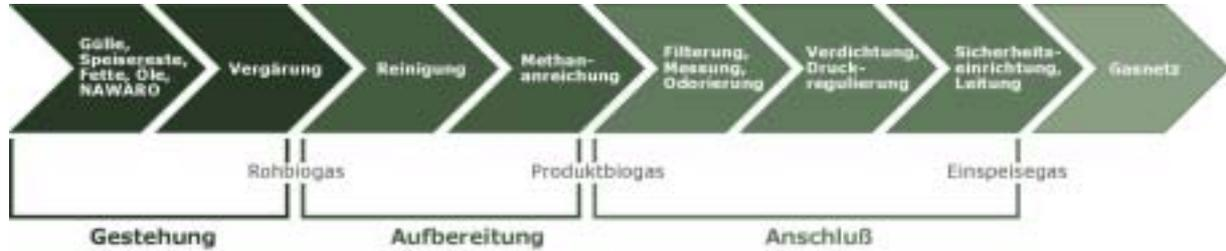
Abbildung 1: Verfahrensschritte bei der Biogas-Netzeinspeisung
