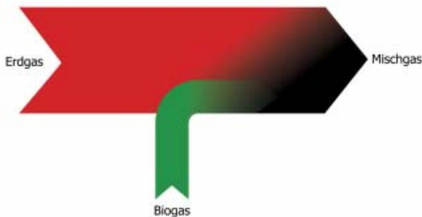
Ohne Änderung der derzeit gültigen Bestimmungen für den minimal zulässigen Brennwert des Gases<sup>3</sup> kann Biogas mit einem maximalen Volumsanteil von etwa 5,6 % dem Erdgas beigemischt werden. Dann könnten jedoch nur etwa 10 % des in Österreich technisch verfügbaren Biogaspotenzials als Zusatzgas in das Gasnetz eingespeist werden. Die restliche Menge müsste weiterhin kostenaufwendig mittels Methananreicherung auf Erdgasqualität gebracht werden.
