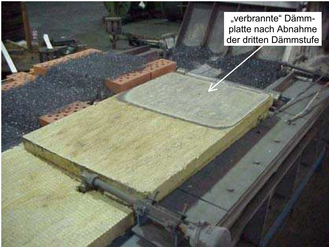
Abbildung 3.16: Steinwolle-Dämmplatte nach den Dämmversuchen und nach Abnahme der dritten Dämmstufe
