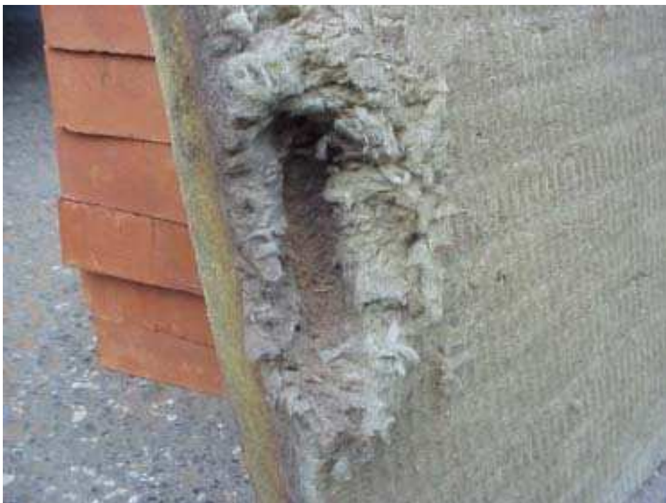
Abbildung 3.17: Steinwolle-Dämmplatte nach den Dämmversuchen – Detailansicht der „verbrannten“ Schicht
