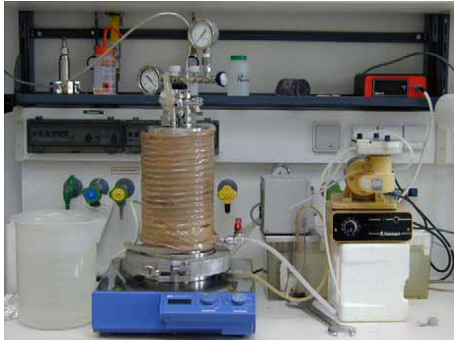
Abb. 47: Nanofiltrationszelle des Institut für Lebensmitteltechnologie der Universität für Bodenkultur
