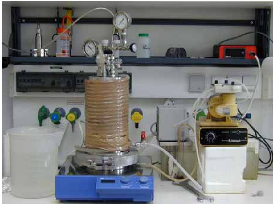
Abb. 12: Nanofiltrationszelle des Institut für Lebensmitteltechnologie der Universität für Bodenkultur
