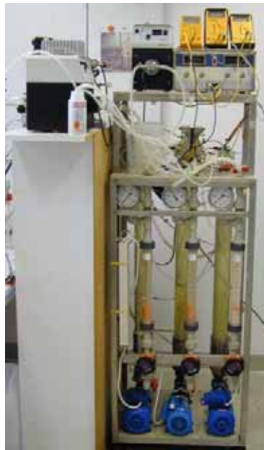
Abb. 53: Elektrodialyseanlage des Institut für Lebensmitteltechnik der Universität für Bodenkultur
