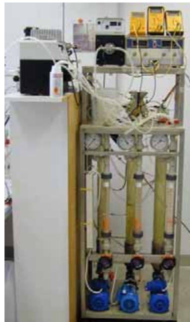
Abb. 15: Elektrodialyseanlage des Institut für Lebensmitteltechnologie der Universität für Bodenkultur
