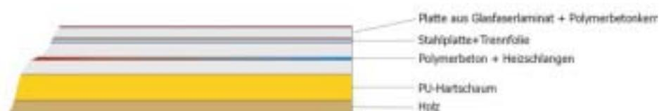
Abbildung 7.4: Aufbau des Tisches mit Platte
