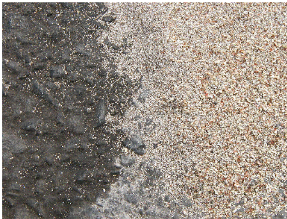
Abb. 83: Versuch mit einer Mischung aus 10% mineralischer Ölbinder und 90% MAG 0/20
