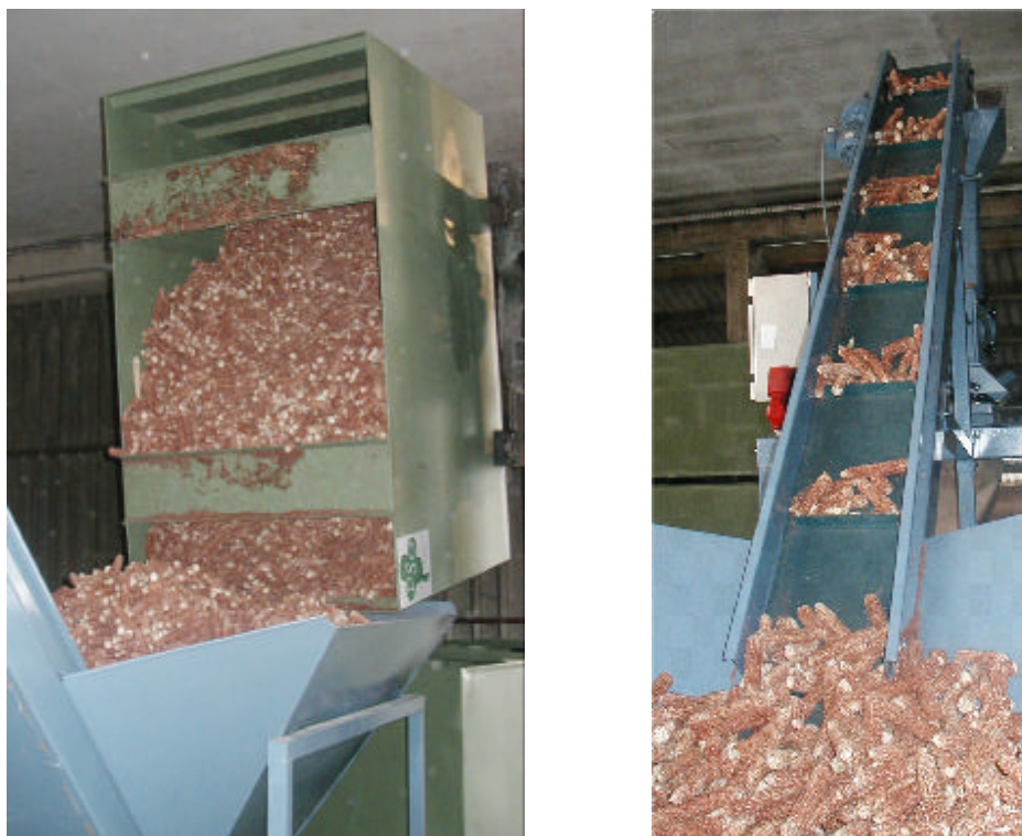
Abb. 63: Befüllung des Vorlagetrichters und Zufuhr des Mahlgutes mittels Bandförderer mit Stegen
