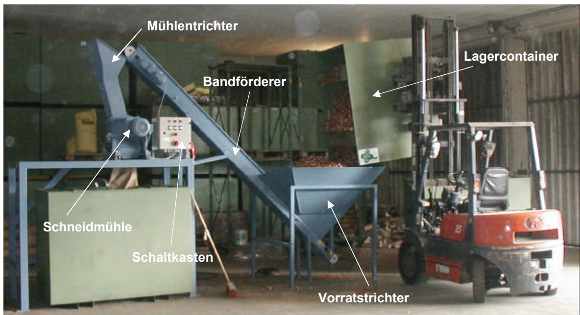
Abb. 9: Mühlenpilotanlage im Vollbetrieb; Befüllung über Stapler mit Drehkranz
