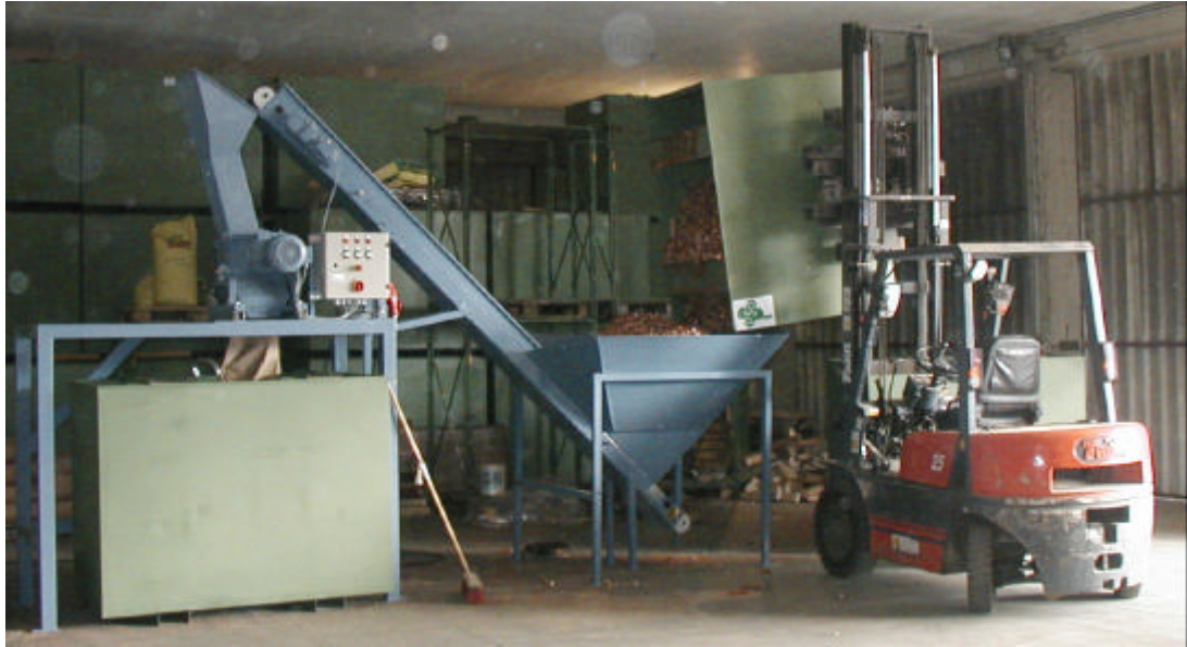
Abb. 64: Mühlenpilotanlage im Vollbetrieb; Befüllung über Stapler mit Drehkranz
