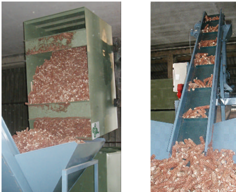
Abb. 10: Befüllung des Vorlagetrichters und Zufuhr des Mahlgutes mittels Bandförderer mit Stegen
