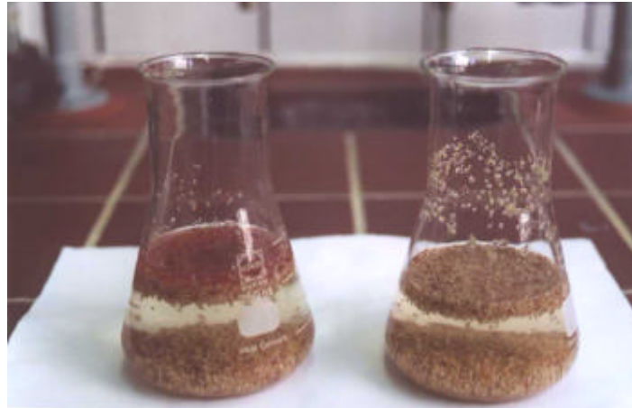
Abb. 7: Schwimmversuch Heizöl Extra Leicht und Wasser, nach 4 Stunden
