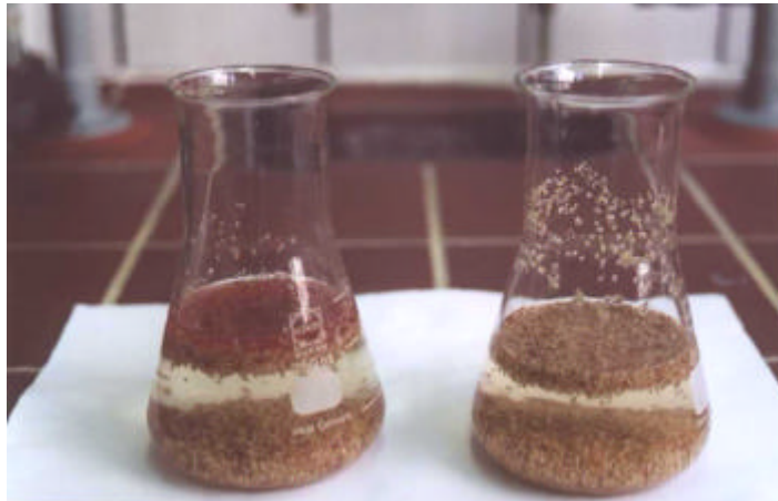
Abb. 56: Schwimmversuch Heizöl Extra Leicht und Wasser, nach 4 Stunden
