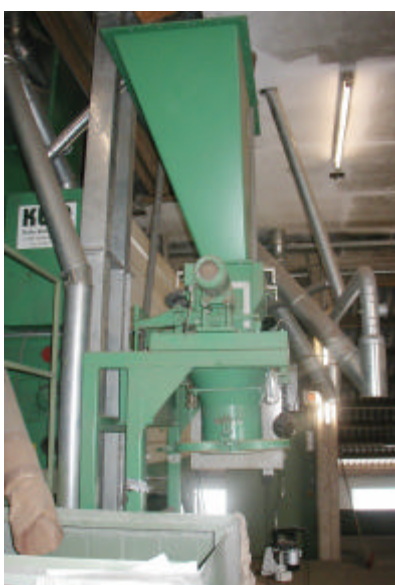
Abb. 12: Absackstation mit Wägvorrichtung zur präzisen Gewichtsabfüllung der Fertigware
