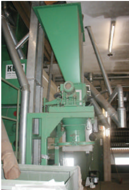
Abb. 61: Absackstation mit Wägvorrichtung zur präzisen Gewichtsabfüllung der Fertigware
