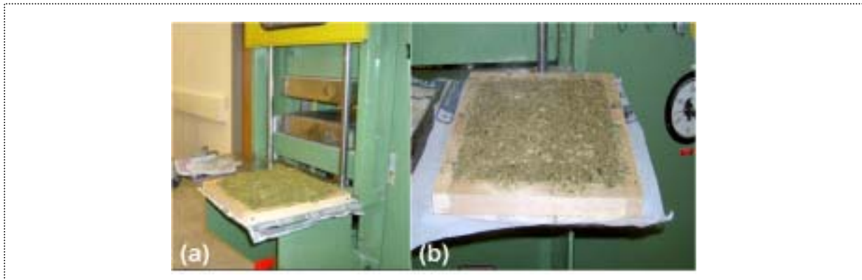
Abb. 7-3a: Heizpresse zur Herstellung der Probplatten: (a) Einfüllen der Faser-Bindemittel-Mischung in den Pressrahmen, (b) Probplatte nach dem Verpressen.
