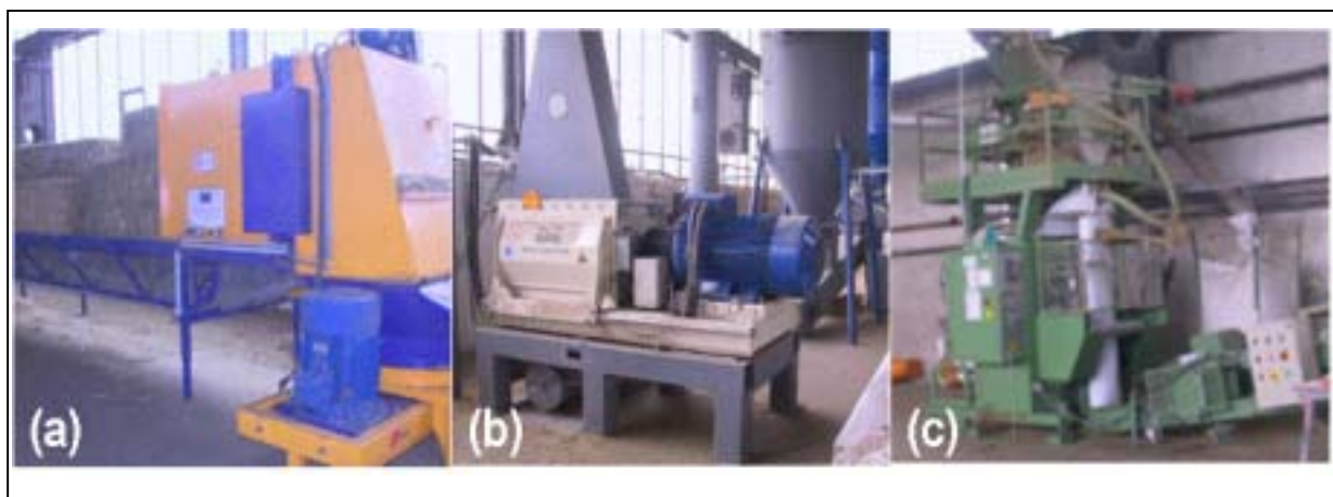
Abb. 10-6: Systemkomponenten der verwendeten Pelletieranlage: (a) Ballenauflöser, (2) Hammermühle für Feinzerkleinerung des aufgelösten Halmgutmaterials, (3) Absackmaschine zur Verpackung der fertigen Pellets.
