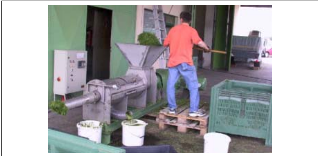
Abb. 4-7: Mechanische Fraktionierung von gehäckselter Grassilage in eine flüssige Fraktion (Presssaft) und in eine feste Fraktion (Presskuchen).
