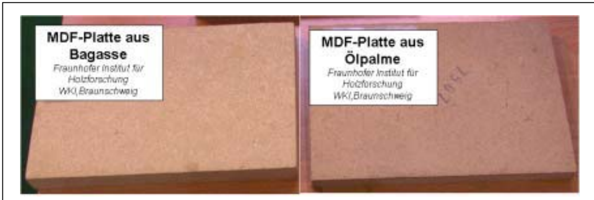
Abb. 3.3.2-1: Beispiele für MDF-Platten aus verschiedenen Einjahrespflanzen (Bagasse, Ölpalme) des Fraunhofer Instituts für Holzforschung Wilhelm-Klaudnitz-Institut (WKI). Fotos stammen aus [Brandstätter 2002].
