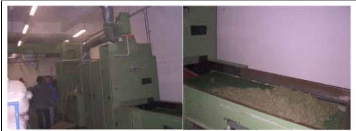
Abb. 6-18: Gesamtansicht der Technikumsanlage zur Herstellung von Faserflocken und Faservliesen nach dem Kardiervfahren.
