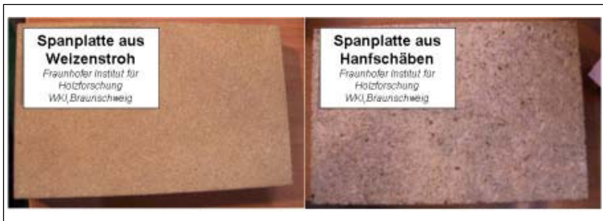
Abb. 3.3.1-1: Beispiele für Spanplatten aus verschiedenen Einjahrespflanzen (Weizenstroh, Hanfschäben) des Fraunhofer Instituts für Holzforschung Wilhelm-Klaudnitz-Institut (WKI). Fotos stammen aus [Brandstätter 2002].
