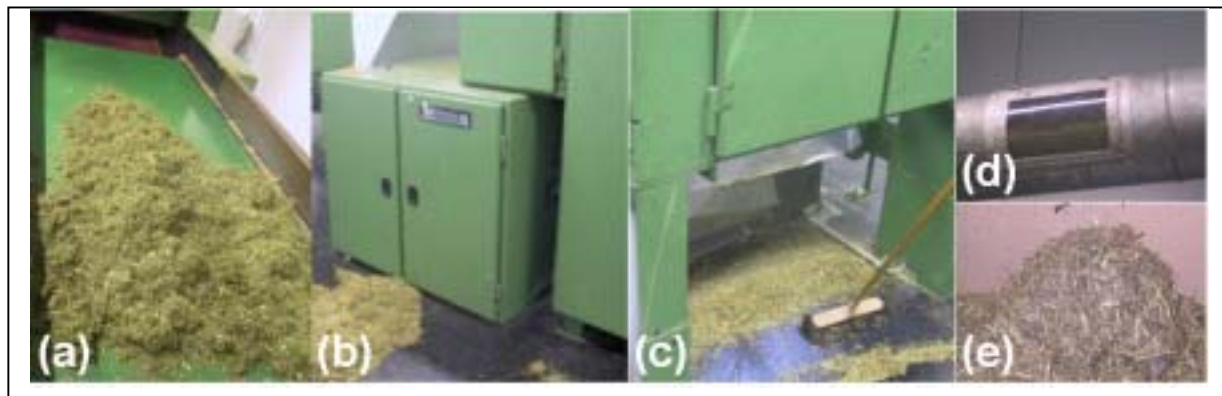
Abb. 6-19: Details der Technikumsanlage: (a) Zuführtisch: Hier erfolgte die Aufgabe des losen Grasfasermaterials, (b) Ballenöffner – Seitenansicht, (c) „Schmutz“ im Abfallraum des Ballenöffners, (d) pneumatische Förderleitung – verstopft durch Grasfasermaterial, (e) Grasfasermaterial im Flockenspeiser der Karde, das jedoch aus dreierlei Gründen für eine sinnvolle Weiterverarbeitung auf der Karde (Faserflorbildung) ungeeignet ist: zu kurz, zu wenig schlank und zu brüchig.
