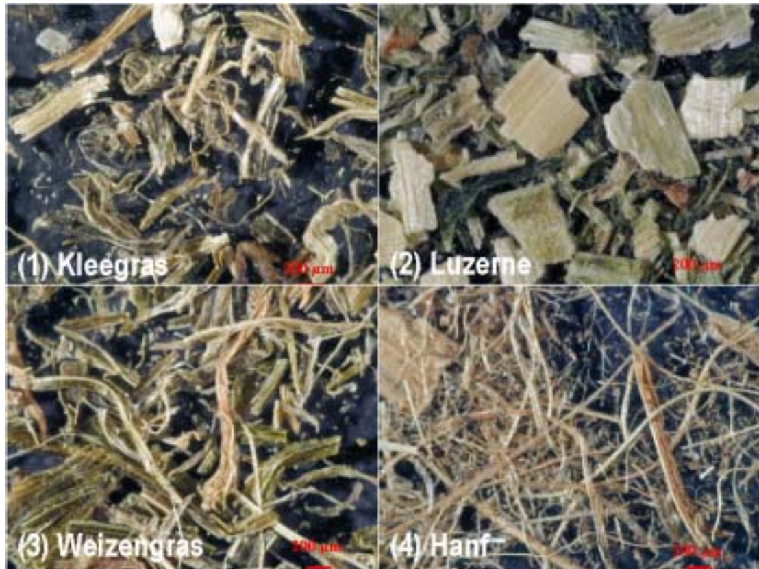
Abb. 6-11: Mikroskopische Aufnahmen des Mahlguts des von einer Schneidmühle erzeugten Mahlguts verschiedener Grasproben (Kleégras, Luzerne, Weizengras) sowie einer Hanffaserprobe.
