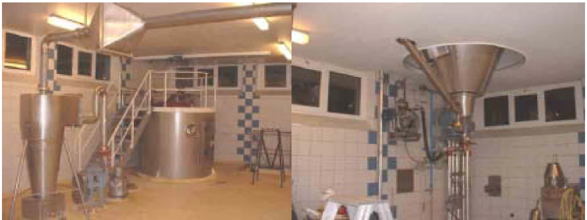
Abb. 89: Versuchssprühturm der Fa. LactoProt – Hartberg (Foto: Kornberg Institut)
