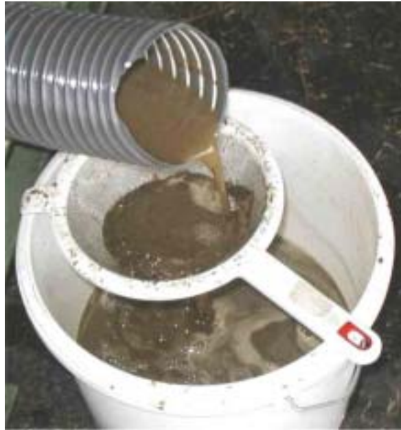
Abb. 35: Silagepresssaft der Pressversuche 2002 mit den Produkten Milchsäure und Proteine (Aminosäuren) (Foto: Kornberg Institut)
