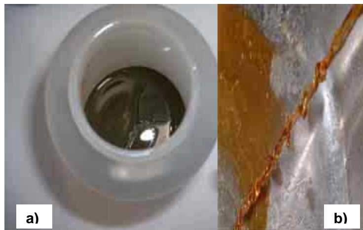
Abb. 48: Zentrifugierversuche des Jahres 2001 (TU-Graz): Foto a) Zentrifugenpellet im Zentrifugenbecher (Proteinkonzentrat); Foto b) Zentrifugenüberstand (Brown Juice)
