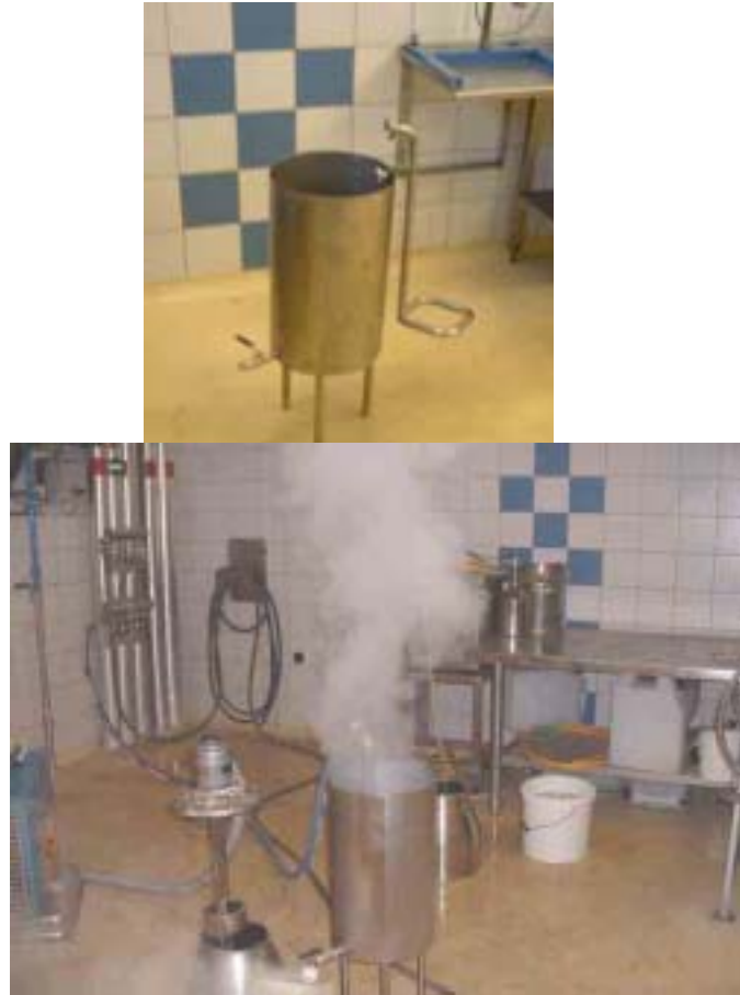
Abb. 47: Steaminjection-Einheit – Sonderanfertigung bei der Fa. LAC- TOPROT AG in Hartberg
