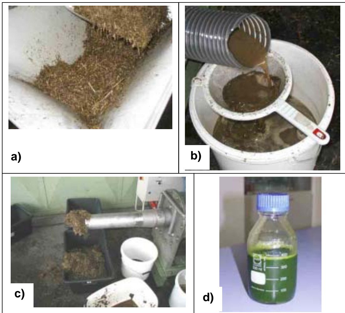
Abb. 8: a) Befüllung der Presse mit Silage, b) Silagepresssaft, c) Silagepresskuchen, d) Luzernepresssaft – Pressversuche 2002 (Fotos: Kornberg Institut)
