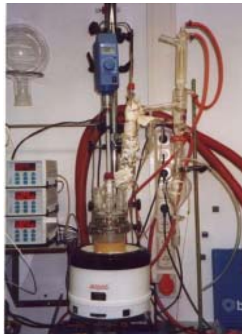
Fig. 54: NF-Permeat des Silagesafts und Destillationsapparat zur Herstellung von Ethyllactat – Univ. Potsdam (D)
