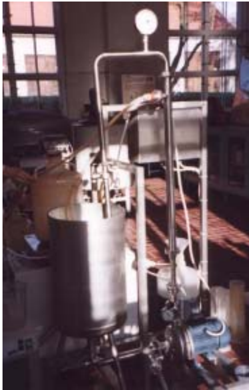
Fig. 50: Mikro bzw. Ultrafiltrationsanlage des ATB-Bornim
