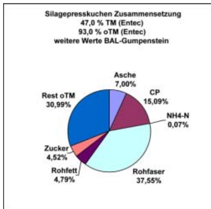
Fig. 71: Zusammensetzung eines BRG01 – IFA-S3 Silagepresskuchens für Biogasversuche
