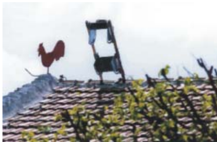
Abbildung G.3.2: Dachmontierte Pyranometer (horizontal bzw. geneigt)
