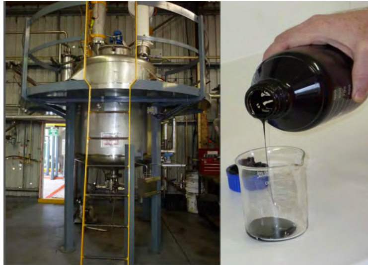
Abbildung 15: Links der Hochdruckreaktor, rechts „Biocrude“ der Licella Pty Ltd
