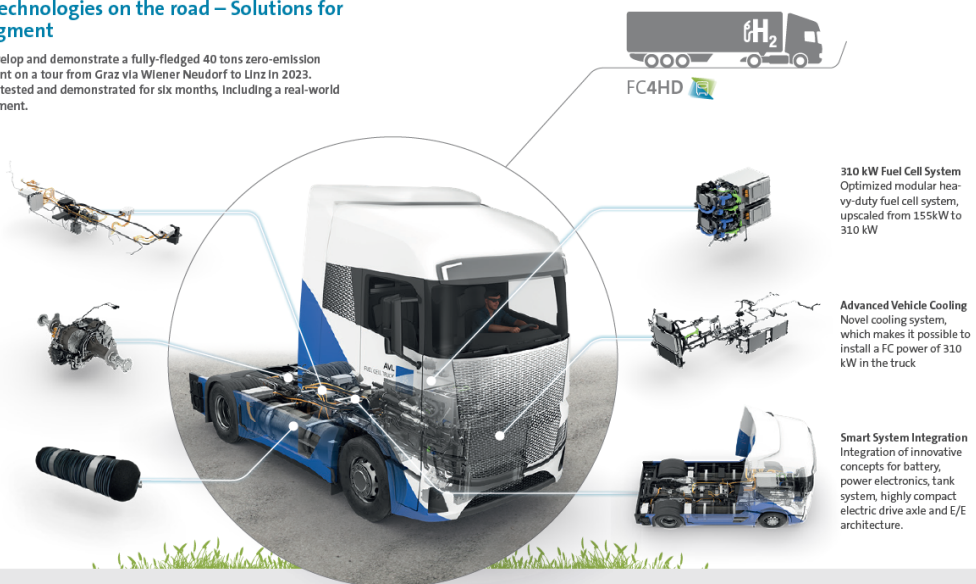
Abbildung 12: Entwicklung eines 40 Tonnen LKW mit Brennstoffzellenantrieb im Zuge des Projekts FC4HD [16]
