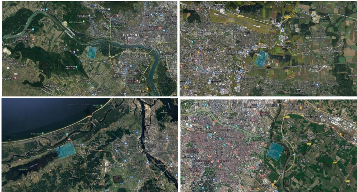
Abbildung 4: Illustration des Flächenbedarfs für eine solarthermische Anlage, die einen solaren Deckungsgrad von 20 % für die Wärmeversorgung erlauben würde. Darstellung von Absolicon (Leitung von Subtask D), beruhend auf Kartenmaterial von Google Maps.
