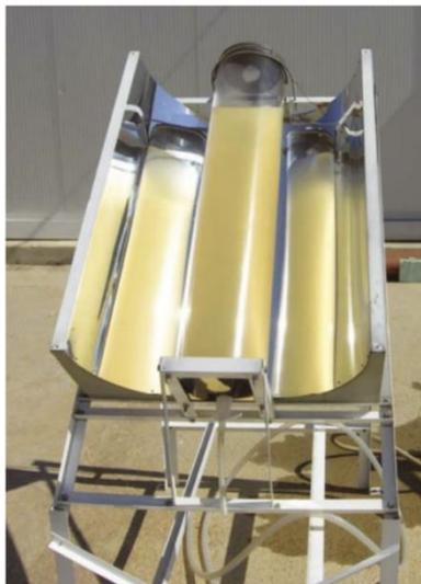
Abbildung 8: Reaktor zur solare Desinfektion (SODIS) (18)
