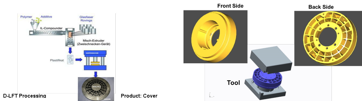
Abb. 7: LFT-Pressverfahren (links) zur Herstellung von großvolumigen Pumpenteilen (rechts) in der Papierindustrie.
