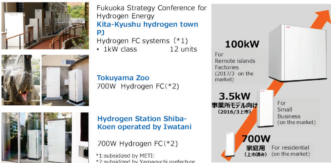
Abbildung 8: KWK-Anwendungen der direkt mit Wasserstoff betriebenen Brennstoffzelle (Quelle: Toshiba) 13
