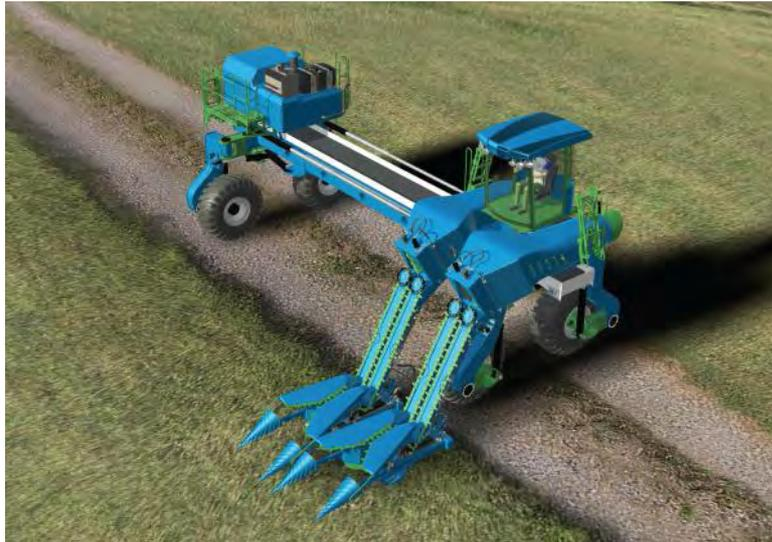
CAD-Entwurf eines Zuckerrohrvollernters mit geringer Bodenverdichtung
