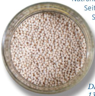
*Das Sorptionsmaterial Zeolith 13XBF wird in verschiedenen Formen angewendet, wie hier in Form kleiner Kügelchen.*
