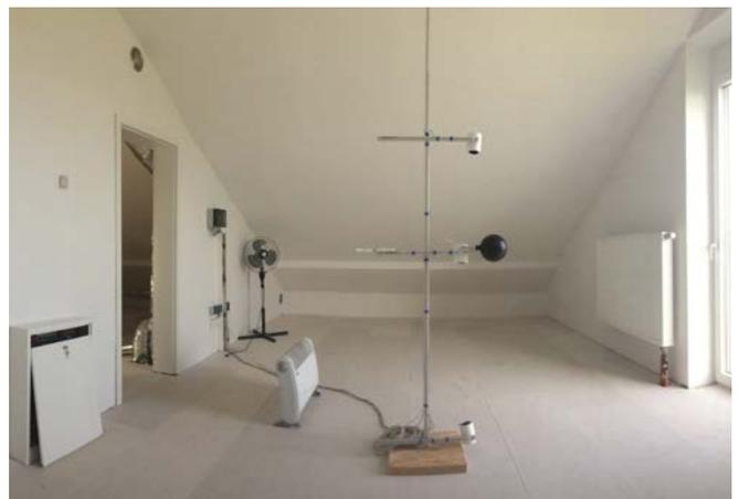
Experimenteller Messaufbau in einem der Räume der sogenannten Zwillingshäuser. Diese Testhäuser des Fraunhofer-Institut für Bauphysik wurden genutzt, um Messdaten für die Validierung von Simulationsmodellen und Charakterisierungsmethoden zu generieren. © Fraunhofer IBP
