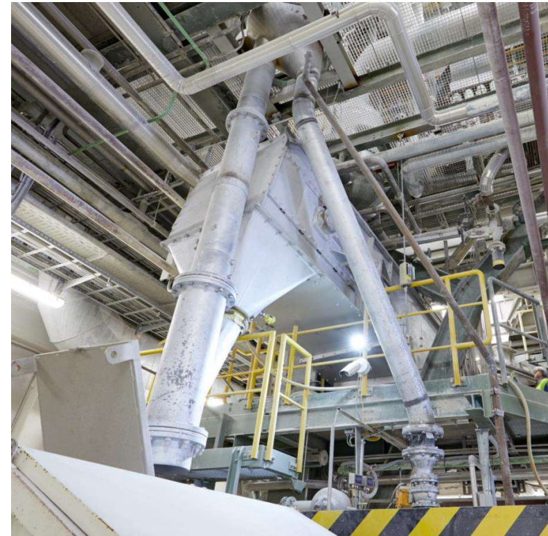
Plattenförderer mit Windsichter und Abscheider
