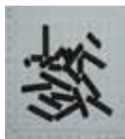
Torrefizierte Pellets H_u : 23.300 kJ/kg TS Schüttgewicht : ~ 650 kg/m 3
