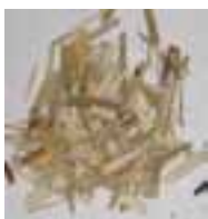
Rohstoff (Miscanthus) H_u : 17.500 kJ/kg TS Schüttgewicht: 150 kg/m 3
