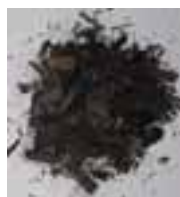
Torrefiziertes Material H_u : 23.300 kJ/kg TS Schüttgewicht : 200 kg/m 3
