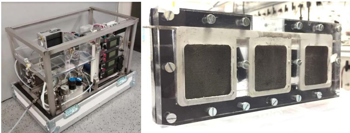
**Abbildung 2:** Prototypen, links: H<sub>2</sub>-Freisetzungsreaktor mit PEM-Brennstoffzelle, rechts: Direkt-Borhydrid-Brennstoffzelle (Quelle: Technische Universität Graz, ICVT, 2017).
