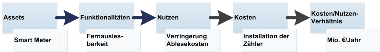
Abbildung 4-4: Ablauf der Kosten-Nutzen Analyse nach der Methode des JRC (Darstellung analog zu JRC, Übersetzung aus dem Englischen)
