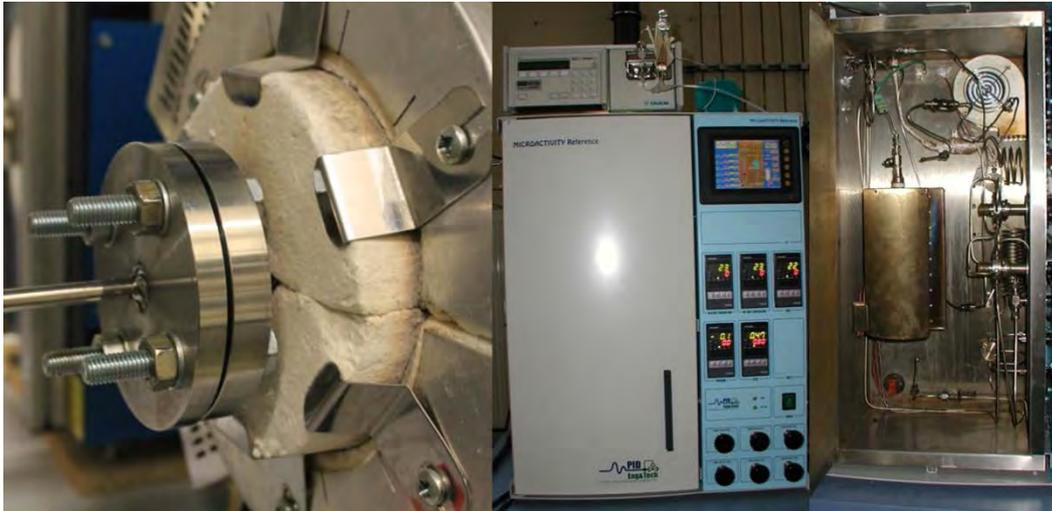
Abbildung 1: Detailaufnahme des Prototypreaktors (links) und automatisierter Teststand (Mitte und rechts) (Qu.: Technische Universität Graz, ICVT, 2013)
