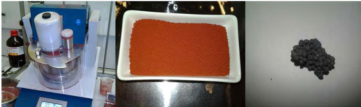
Abbildung 14: Mischer zur Herstellung von Eisenproben (links), frische Eisenproben (Mitte) und Proben nach mehreren Reaktionszyklen (rechts) (Qu.: Technische Universität Graz, ICVT, 2013)
