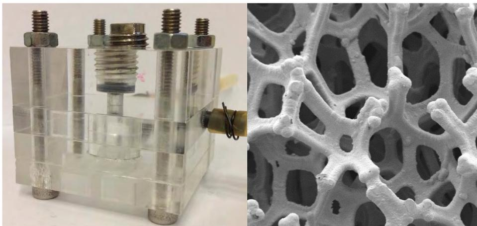
Abbildung 2: Links: Analysezelle für Katalysatormaterialien; rechts: Struktur der Katalysatormaterialien
