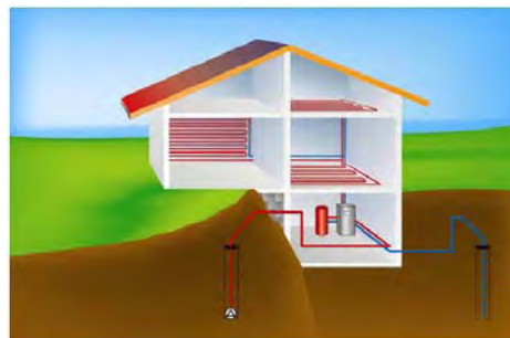
Abbildung 3: Prinzip der Wasser/Wasser-WP (Böswarth et al., 2006)
