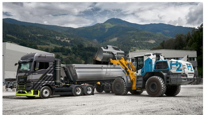
Abb. 1: Wasserstoffradlader-Prototyp L 566H mit MAN Wasserstoff LKW. Beide Fahrzeuge werden mit Wasserstoffmotoren angetrieben. © Liebherr-Werk Bischofshofen GmbH
