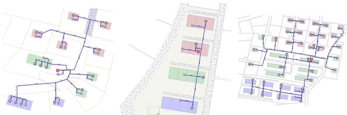
Fig. 29: Grundriss zu den Modellsiedlungsgebieten 1 - 3 / inkl. zentraler Wärmeversorgung. Diese werden in drei Bauabschnitten (unterschiedliche Farben) zu jeweils zwei bis drei Jahren errichtet.
