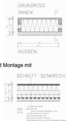
Fertigteil - Konstruktionsprinzip
