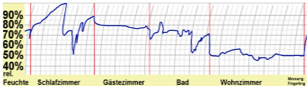
Abb. 15: Gemessene Luftfeuchtigkeit in einem Altbau mit Feuchteschäden (Messung KH Fingerling). [Quelle: KH Fingerling, PHI]
