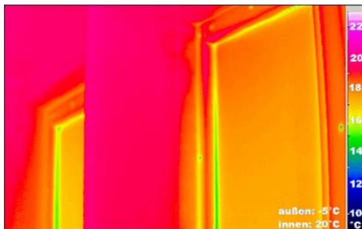
Abb. 18: Thermographische Aufnahme eines Passivhausfensters (raumseitig). [Quelle: TREBERSPURG, M., 2006]
