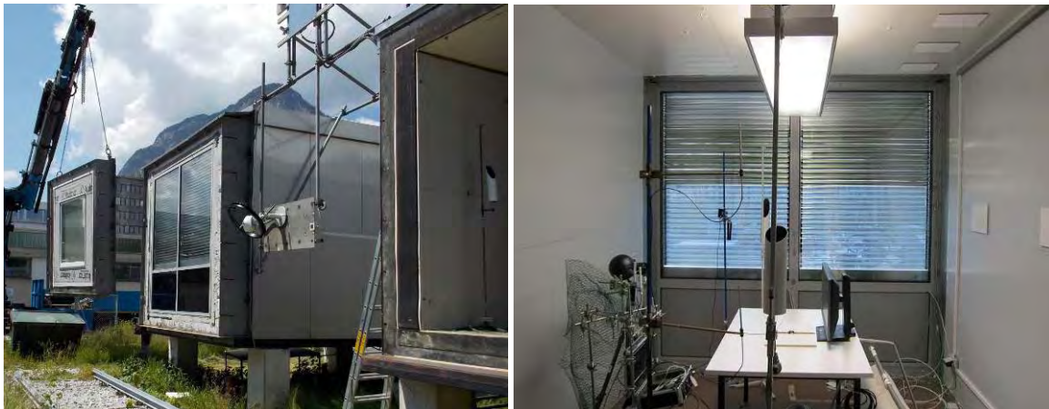
Außenteststände (PASSYS-Testzellen) am Campus der UIBK. Fassadenmontage (links), Innenansicht des Testraums mit Tageslichtsystem und LED-Beleuchtung (rechts)
