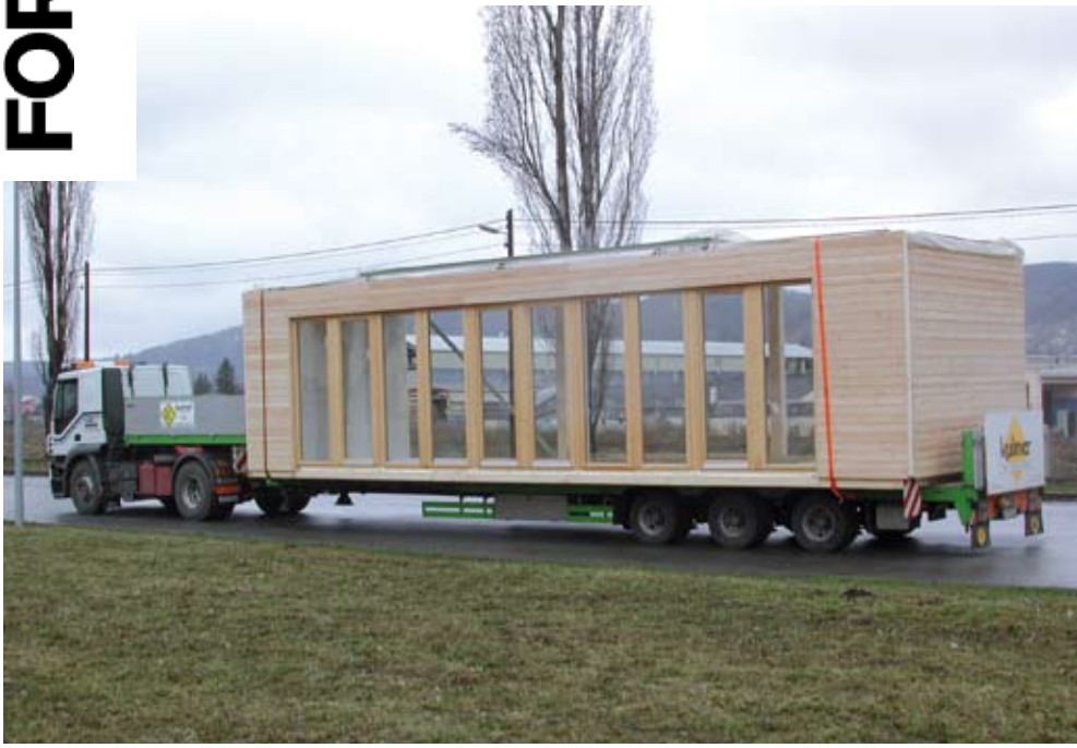
Abb. 4, 5: Raummodule mit Kreuzlagenholz am Beispiel Impulszentrum Graz: Transport mittels Lkw zur Baustelle, Modulstoß-Fassade. Fotos Riess
