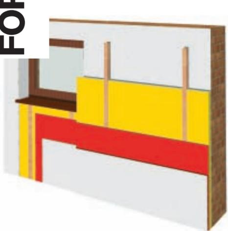
Abb. 5: Innendämmung mit Dampfsperre und Verkleidung. Grafik: Energie Tirol
