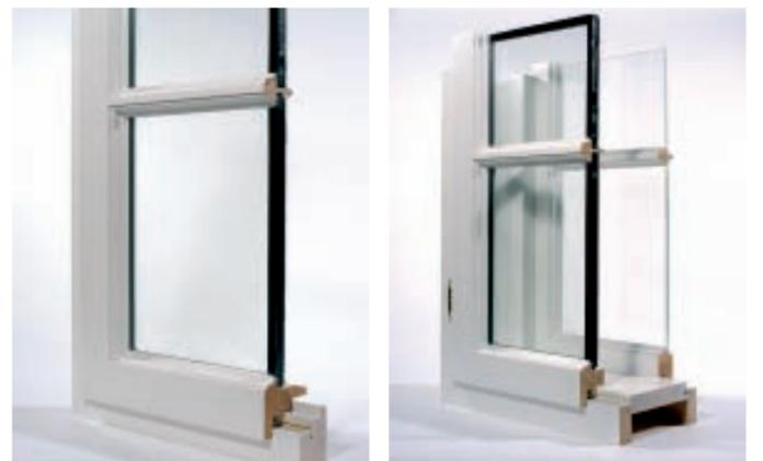
Abb. 3, 4: Energie Tirol: Nachbau eines historischen Fensters mit Zweischeiben-Wärmeschutzverglasung. Beim Kastenfenster wird die Wärmeschutzverglasung im Innenflügel ausgeführt. Fotos: Watzek
